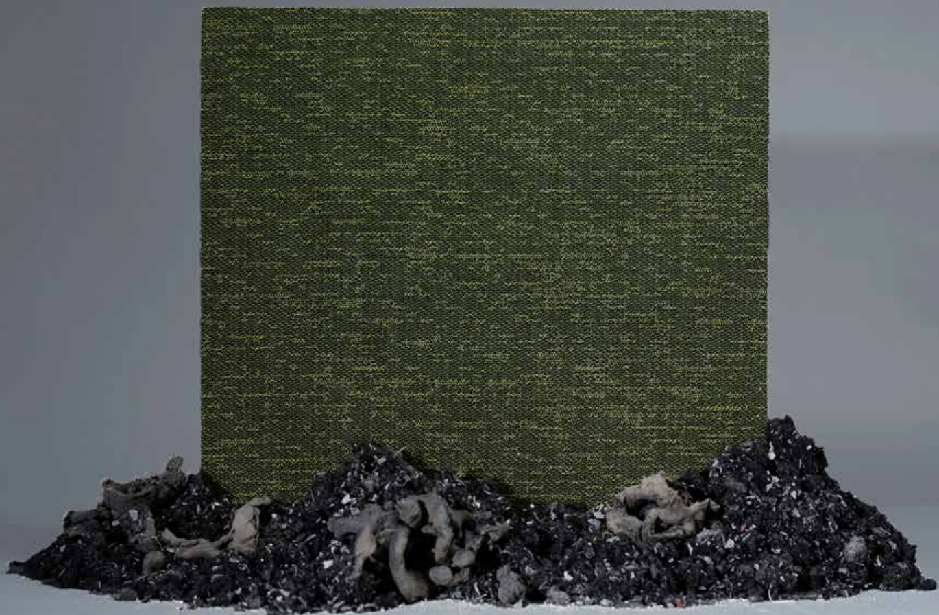
Circulariteit: recuperatiemateriaal uit afvalstromen wordt gebruikt in nieuwe tegels
