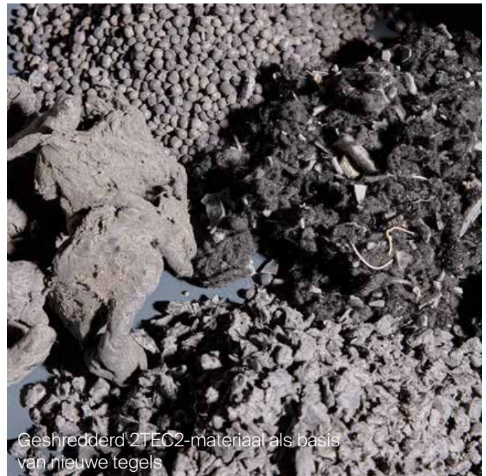
2TEC2-afval wordt tot nieuwe grondstof geshredderd
